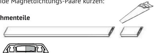
Länge = Bodenluft + Flügelhöhe + 5 mm Überstand oben
